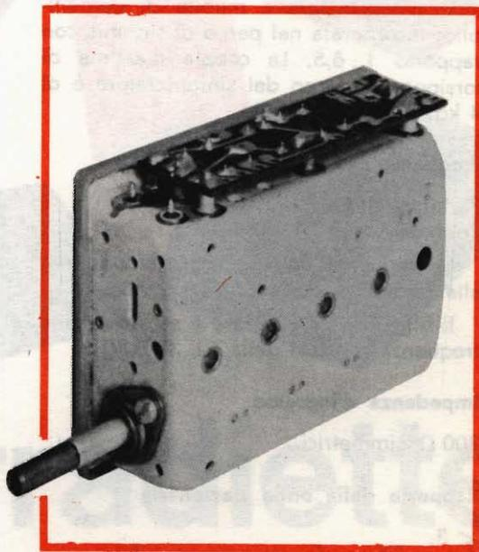
Fig. 1 - Sintonizzatore UHF a transistor con circuito per il controllo della frequenza dell'oscillatore.
