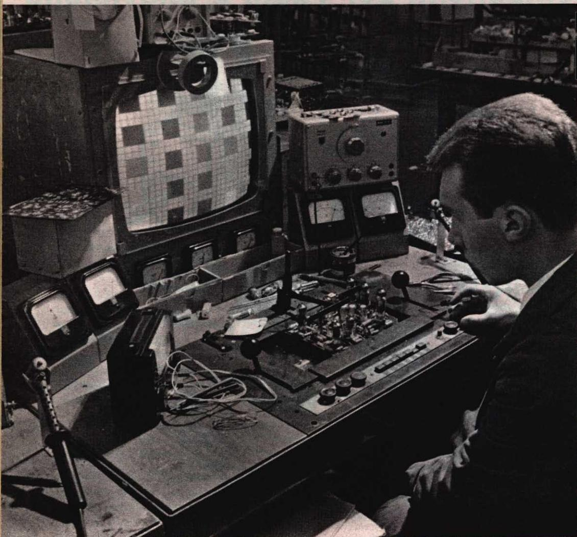
Controllo visivo sullo schermo del cinescopio di un pannello a circuito stampato nel quale si trovano alcuni circuiti di un televisore.
